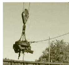
Электромагниты используются в различных приборах в качестве управляемых устройств с магнитным действием, а также в машинах и оборудовании, таких как электромагнитный кран.
